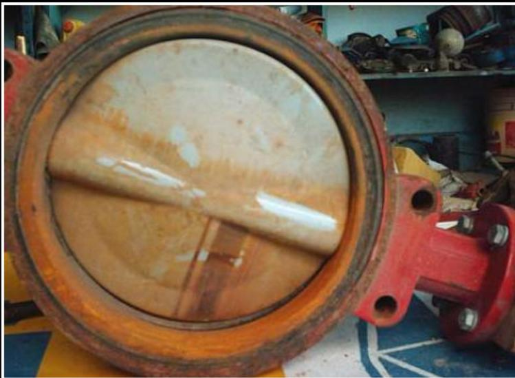
Válvula Mariposa Bray con Disco Recubierto de Nylon 11 después de 4 años de Servicio en Agua Potable
