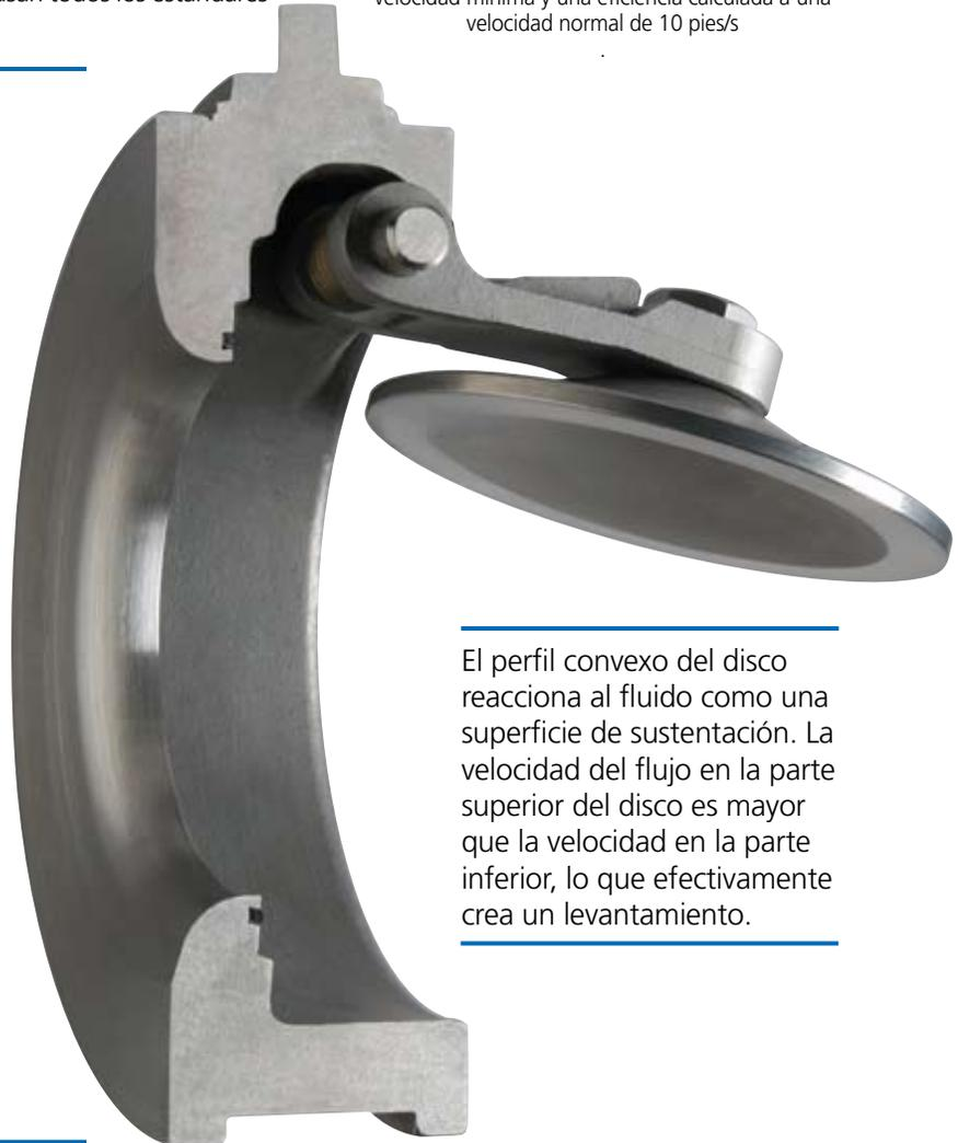
El perfil convexo del disco reacciona al fluido como una superficie de sustentación. La velocidad del flujo en la parte superior del disco es mayor que la velocidad en la parte inferior, lo que efectivamente crea un levantamiento.
