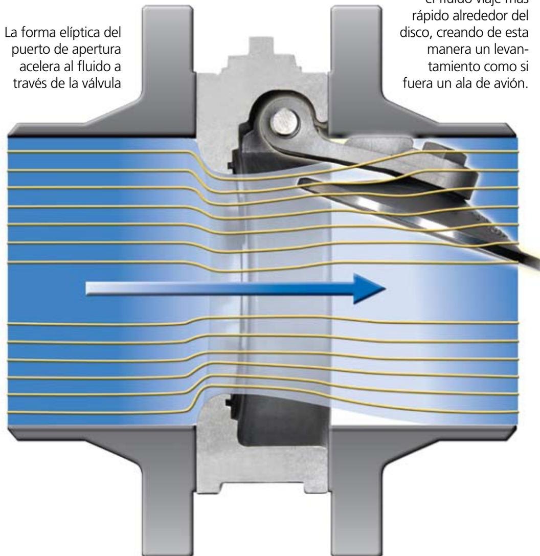
La forma elíptica del puerto de apertura acelera al fluido a través de la válvula
