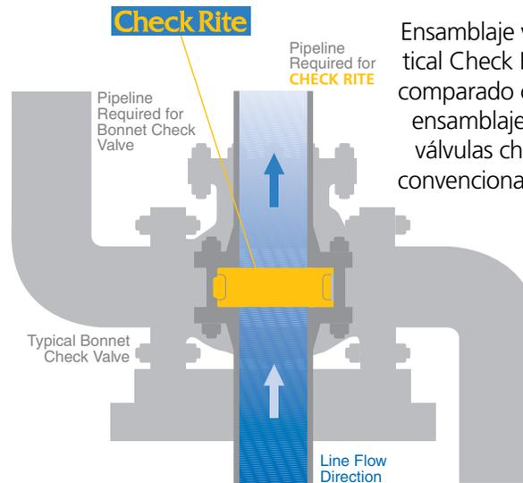
**PESO LIGERO Y TAMAÑO REDUCIDO** El costo de instalación es altamente reducido por las Válvulas Check Rite por su peso ligero y su mínimo espacio requerido. Su diseño compacto minimiza la distancia entre las caras y es de fácil instalación entre bridas. Las Válvulas Check Rite no requieren de soportes adicionales para mantener la integridad de la tubería y necesitan solamente del 30% de espacio de lo que necesita una válvula swing check convencional.
