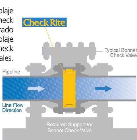
Ensamblaje vertical Check Rite comparado con ensamble de válvulas check convencionales.
