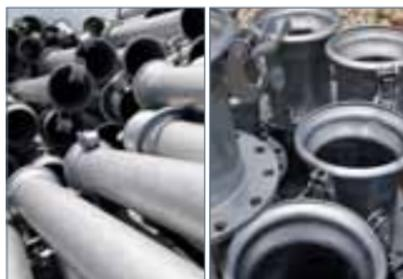
Tubería de desconexión rápida y adaptadores
