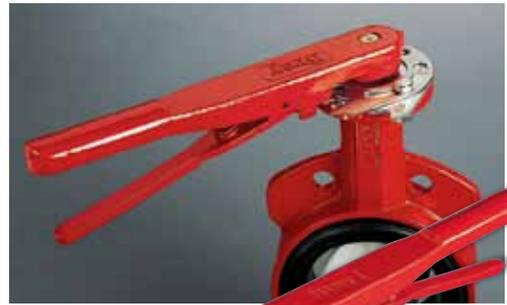
**EL JUEGO DE CANDADOS** le permite al cliente bloquear la válvula en una posición completamente abierta o cerrada, lo que hace que la válvula permanezca a prueba de manipulación. Al perforar un nuevo orificio en la placa superior, la palanca se puede bloquear a mitad del trayecto.
