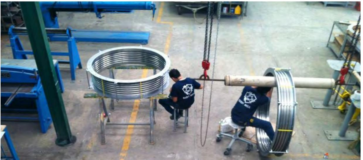
Las Juntas de Expansión son dispositivos flexibles diseñados para absorber los movimientos generados en los sistemas de tuberías por variaciones de temperatura y presión. Al absorber los movimientos reducen la vibración mecánica ocasionada por otros equipos y disminuye el ruido de la tubería.
