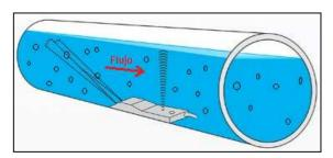
Características Metrológicas: El transductor del medidor es fácil de instalar y no se necesita realizar ningún tipo de obra civil o instalación de vertederos y canaletas para cuantificar el gasto del fluido. El medidor Ultra AV puede grabar datos de flujo instantáneo y totalizador; dicha información es sustraída por medio de una tarjeta SD de hasta 16 GB, además cuenta con una autonomía en su batería recargable de hasta 40 horas de uso.
