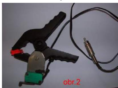
Contactor ESTOP con sujetador
