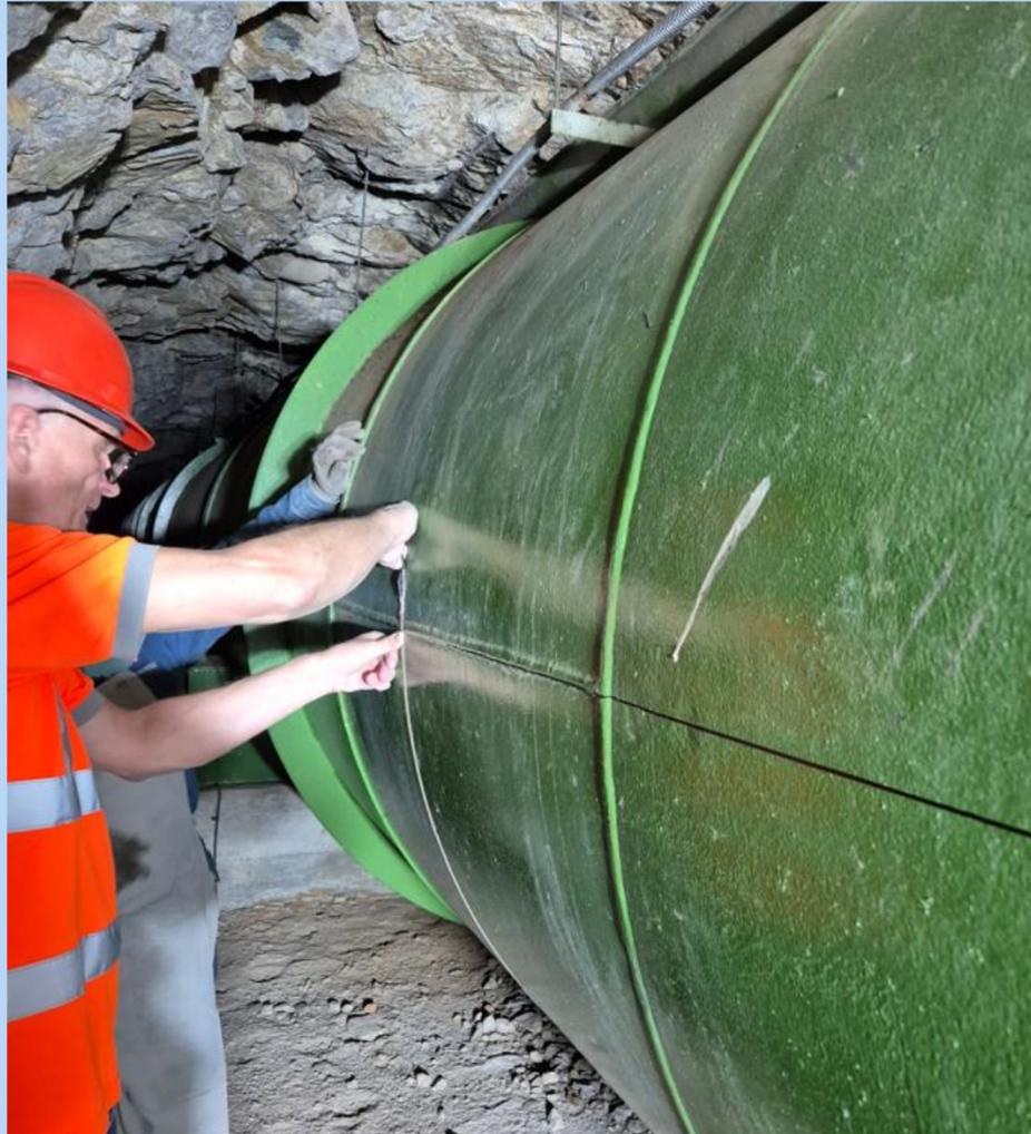
Toma de medición en tubería de 1.8 metros de diámetro, incluyendo el marcado de la ubicación de los sensores.
